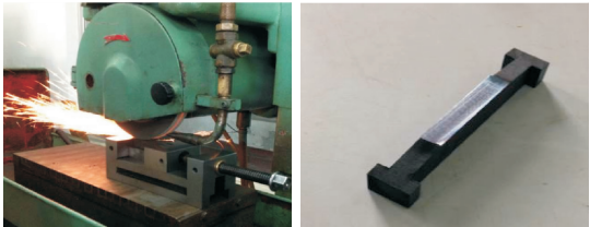
图 6 预应力淬硬磨削过程与试件
