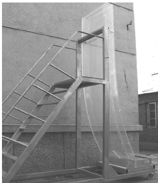
图 1 直弧型结晶器示意图
