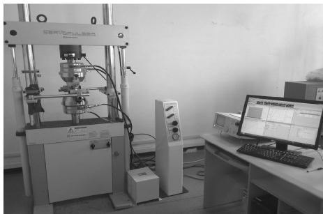
图 2 低频疲劳试验机 Fig. 2 Low frequency fatigue test machine
