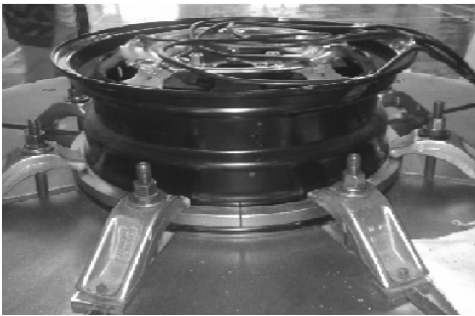
图 2 弯曲疲劳试验的装置图 Fig. 2 Device map for bending fatigue test
