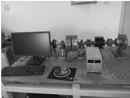
图3 磁流变制动器试验台 Fig. 3 Test bench of MR brake
