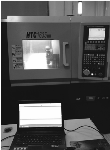
图 2 z 轴的空载试验 Fig. 2 No-load experiment of z-axis
