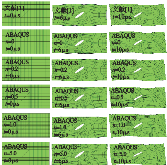
图 11 不同时间步时倾斜裂纹功能梯度板的变形图 Fig. 11 Deformation figures of inclined-crack functionally graded plate under different time steps
