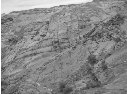
图 3 地表岩体节理发育情况 Fig. 3 Joint development in surface rock mass
