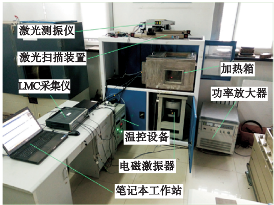
图 2 热振环境下纤维增强悬臂复合薄板固有特性测试现场
