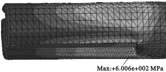
图 3 插孔簧片的等效应力云图 Fig. 3 Equivalent stress cloud of jack reed
