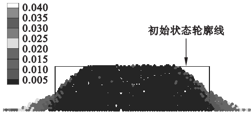
图 6 a=0.6 时最终堆积水平位移(单位:m) Fig. 6 Final horizontal displacement of deposit when a=0.6 (unit:m)
