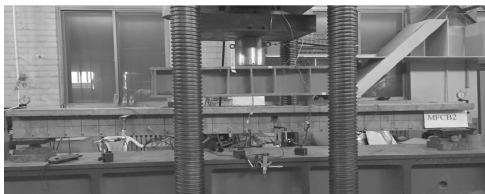
图2 试验加载装置 Fig. 2 Loading device of experiment
