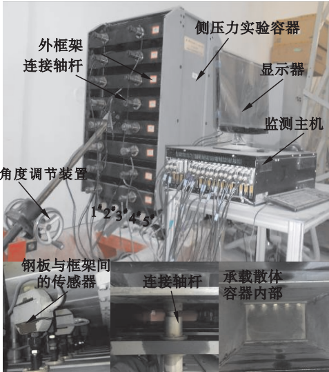
图 1 散体颗粒流动侧向压力测试系统 Fig. 1 Test system of granular lateral pressure
