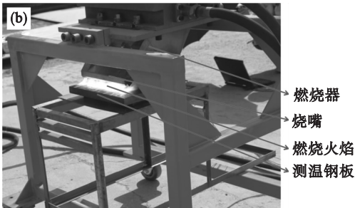
图 1 燃烧试验系统及测温过程示意图 Fig. 1 Schematic diagram of experimental setup (a)—燃烧试验系统; (b)—测温过程.
