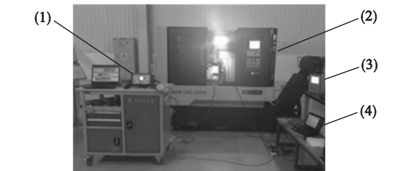
(1)—KISTLER 切削力测试装置;(2)—ETC1625P 数控车床;(3)—基于 FANUC 系统的信号实时采集装置;(4)—激光测距仪数据分析装置
