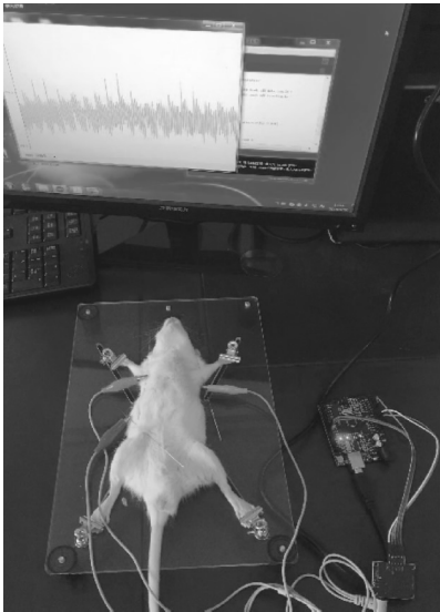
图 1 心电信号实际采集电路 Fig. 1 Actual acquisition circuit of ECG
