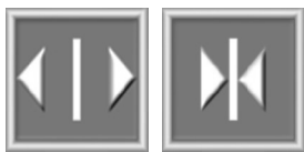
图 3 电梯开关按钮的最优设计方案 Fig. 3 Optimal design of elevator switch button
