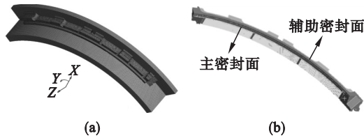
图 3 网格划分与密封环接触面
