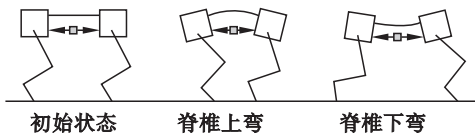
图 2 四足机器人 bound 步态奔跑示意图 Fig. 2 Running diagram of the quadruped robot with bound gait
