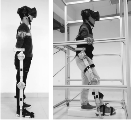
图3 助力外骨骼实验平台
