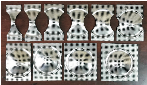
图 7 6016-T4 铝合金的凸模实验成形件 Fig. 7 Convex bulging test samples of 6016-T4 alloy
