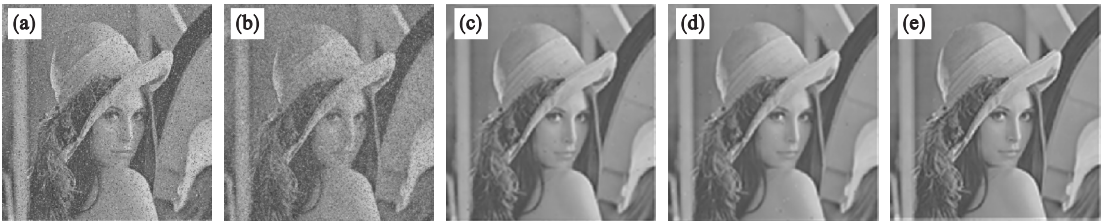
图 7 不同算法处理的 Lena 结果 Fig. 7 Lena results processed by different algorithms (a)—添加 20% 的椒盐噪声;(b)—阶次 0.8 分数阶微分滤波;(c)—中值滤波;(d)—加权中值滤波;(e)—本文算法.
