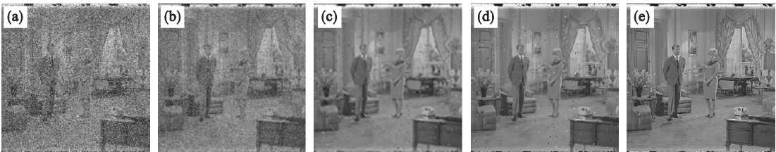
图 8 不同算法处理的 Couple 结果 Fig. 8 Couple results processed by different algorithms (a)—添加 30% 的椒盐噪声;(b)—阶次 0.8 分数阶微分滤波;(c)—中值滤波;(d)—加权中值滤波;(e)—本文算法.
