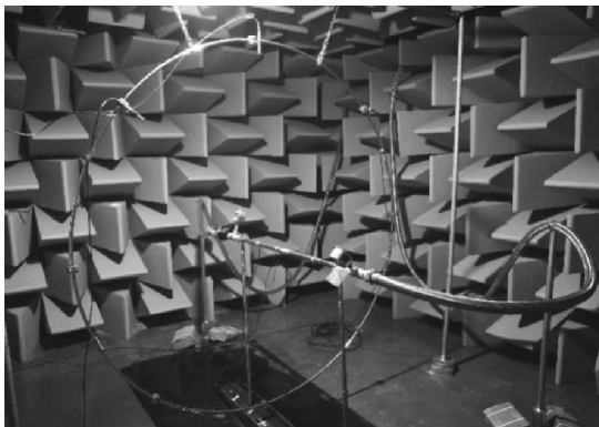
图 3 试样平台布置情况 Fig. 3 Layout of test platform
