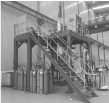
图 3 VIGA 雾化制粉实验设备 Fig. 3 VIGA atomization experimental equipment
