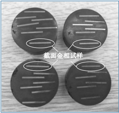
图 2 截面金相试样 Fig. 2 Section metallographic specimens
