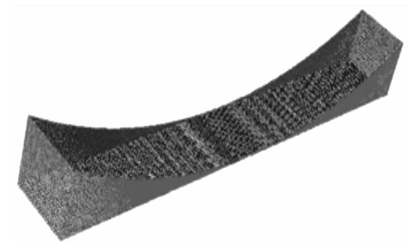
图 1 三维磨削区模型的网格划分 Fig. 1 The mesh grid generation of 3D grinding zone
