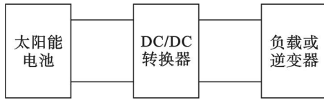
图 1 普通光伏发电系统结构
