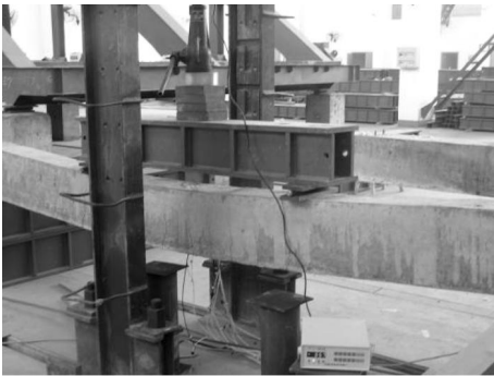
图 3 L1 梁破坏图 Fig. 3 Typical failure mode of L1
