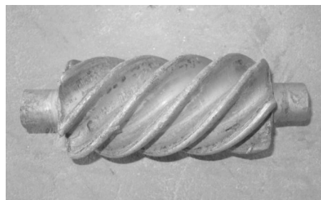
图 8 热态的试验轧件
